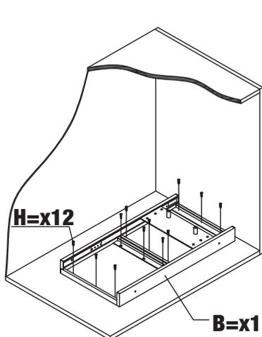
Fijar la estructura a la base del mueble con tornillos.
