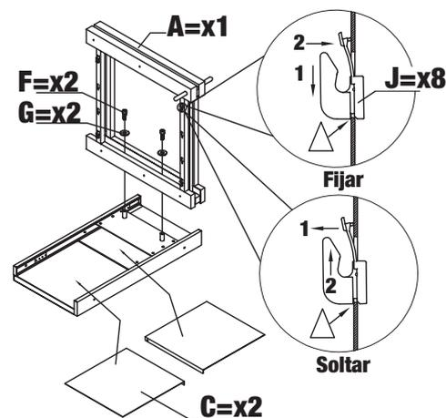
Fijar el bastidor a la estructura de acuerdo a la mano a la que queramos hacer el deslizamiento, y colocar los ganchos a la altura deseada.
